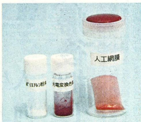
松尾、内田両准教授が開発した（右から）人工網膜フィルムと原料となる光電変換色素、ポリエチレン粉末
