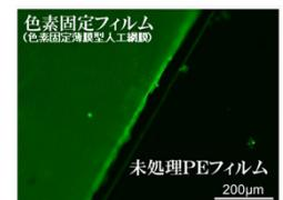
右図の明るい部分が光照射により生じた電位部分
